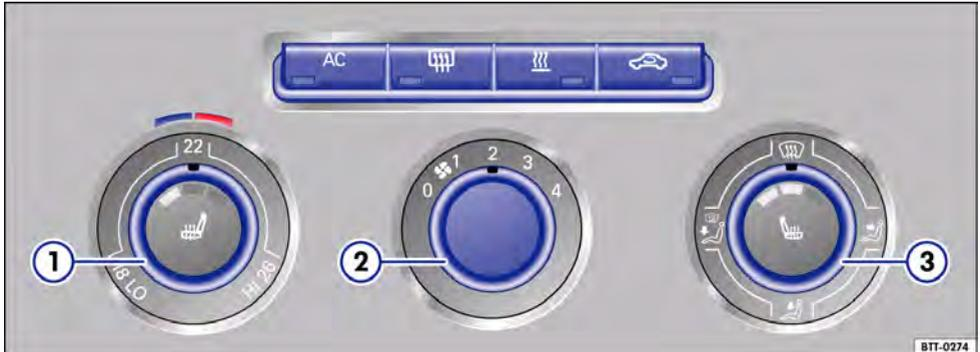
Abb. 1 Bedienelemente Klimaanlage (manuell)
