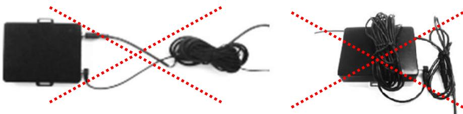
La distance entre le module DAB et les prises d'alimentation doit être d'au moins 10 cm!
