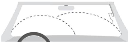
L'antenne doit être montée aussi loin que possible sur la bande en céramique noire du pare-brise (schéma de droite). Cela peut impliquer de détacher le revêtement du pare-brise latéral.
