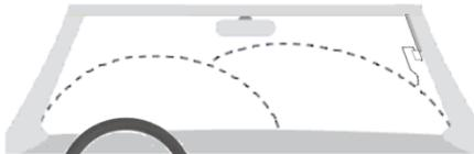
Die Antenne muss so weit wie möglich auf dem schwarzen Keramikstreifen der Scheibe angebracht werden (Bild rechts). Dazu muss ggf. die Frontsäulenverkleidung demontiert werden.
