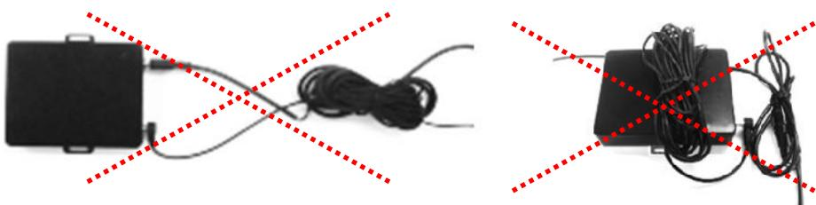
¡La distancia entre el módulo DAB y los cables conectados debe ser 10 cm como mínimo!
